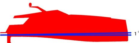
ASSETTO DELL'IMBARCAZIONE MYTIC ALLA VELOCITÀ DI CROCIERA DI 23 KNS
